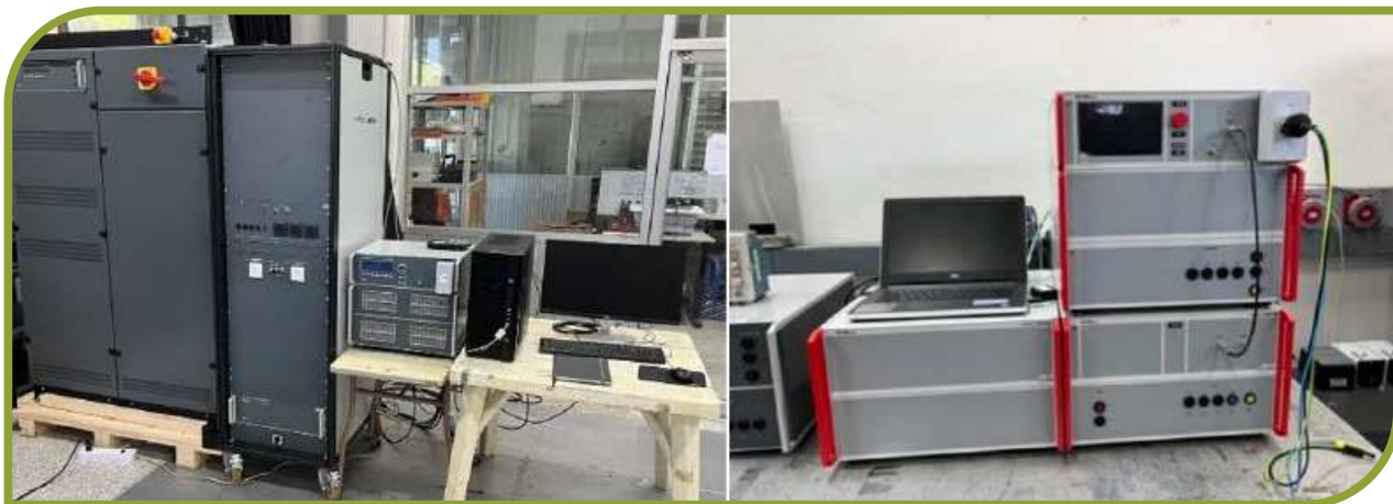
เครื่องมือทดสอบ 3-Phase Harmonic&Flicker system และ Immunity test
