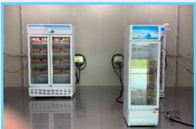
ห้องทดสอบด้านประสิทธิภาพพลังงานสำหรับตู้แช่แสดงสินค้าที่ใช้สารทำความเย็นธรรมชาติ
