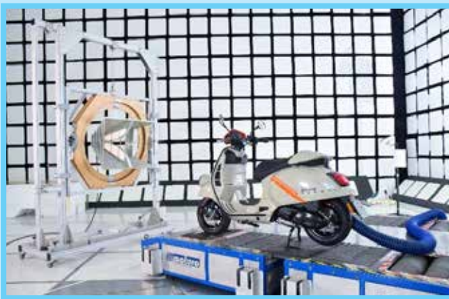
การทดสอบระบบเบรก ABS ด้าน EMC
