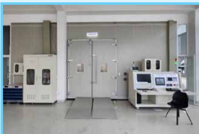
ห้องทดสอบด้านประสิทธิภาพพลังงานสำหรับตู้แช่แสดงสินค้าที่ใช้สารทำความเย็นธรรมชาติ
