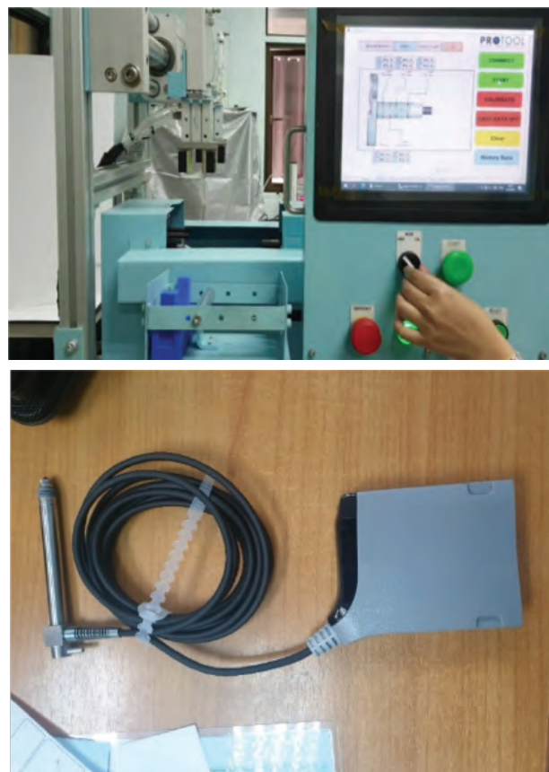
รูปภาพระบบการวัดและอ่านค่าชิ้นงานโดย Inductive Probe Sensor
